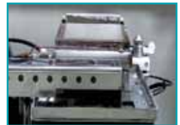
Hagyományos omega-hullámot előállító fej
