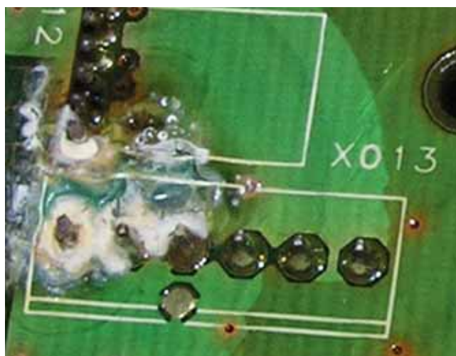
A bevonat delaminációja
