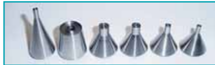
A fúvóka-készlettel 1,5 ... 20 mm közötti átmérőjű minihullámok állíthatóak elő
