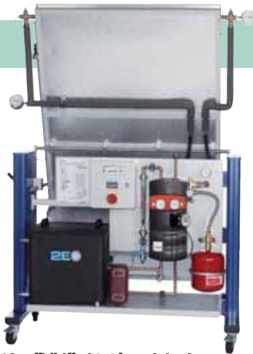
HL 313 működő oktató modul – használati melegvíz készítés napkollektorral
