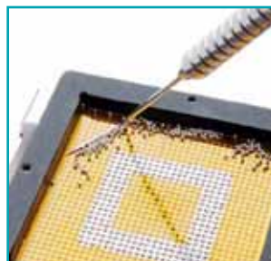
Forró levegős „toll” a hibás bumpok eltávolításához
