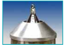
A pont hullám-fúvókából kiáramló forrasztanyag nitrogénatmoszférájú harangba kerül
