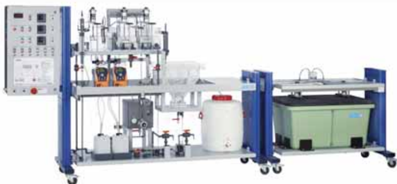
CE 705 működő oktató modul – aktivált szennyvíziszap kezelés
