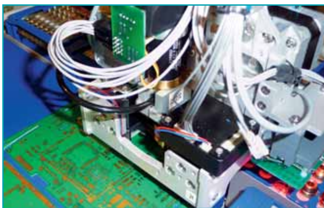
A beültetőfej az optikai központosító-rendszerrel
