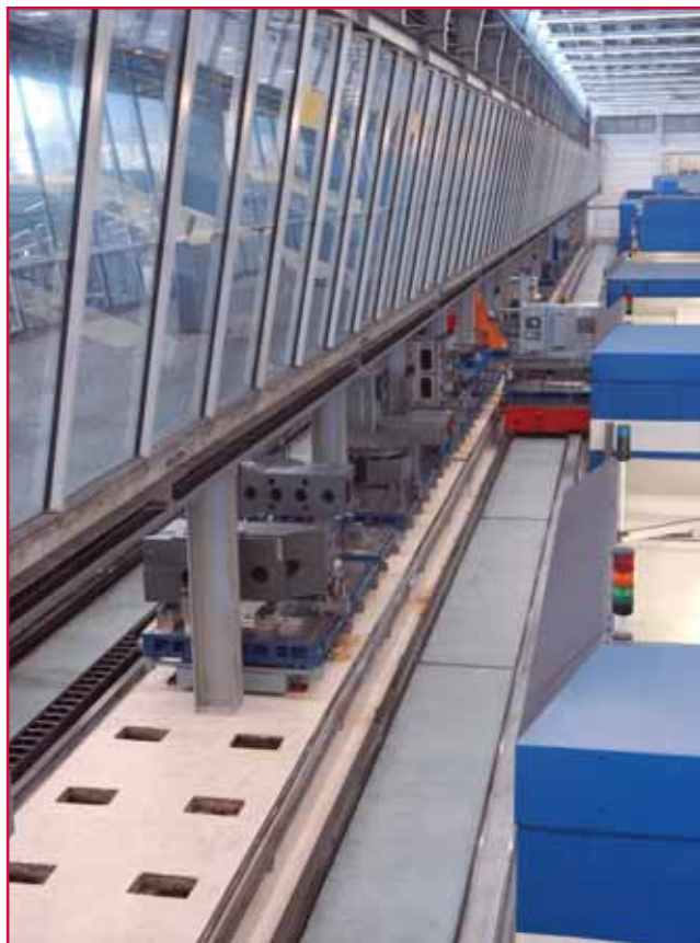
Gyártósor a Kempton Manufacturingnál, teljesen automatizált vertikális és horizontális megmunkálóközpontokkal
