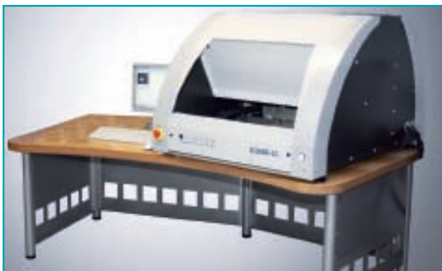
2. ábra. Teljes értékű AOI berendezés az asztalon: Viscom S2088-II rendszer
