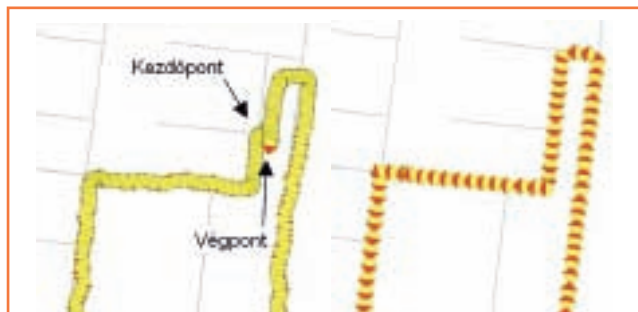
1. ábra. Dead Reckoning helymeghatározás eredménye önmagában, illetve térképillesztéssel. Annak ellenére, hogy az autó indulási és érkezési helye azonos, a DR távolsághiba következtében a térképen a kör kezdő- és végpontja eltér egymástól
