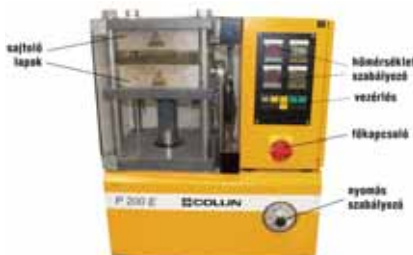
1. ábra. A Collin P200E préselőgép és főbb részei
