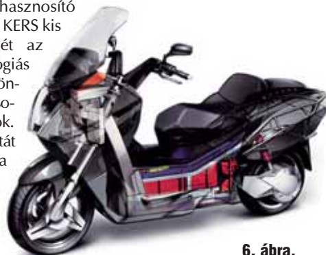
6. ábra. Nagy teljesítményű robogó elektromos hajtással és Murata EVC-kondenzátorokkal
