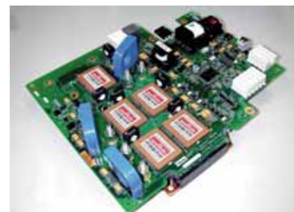
7. ábra. Az 6. ábrán látható robogó teljesítménykonvertere a Murata EVC-kondenzátorokkal
