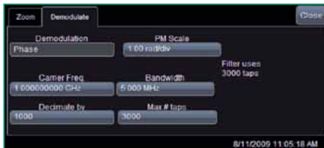
3. ábra. A „dialógus-box” a demodulációs függvény beállításához
