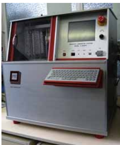
2. ábra. A PTC IL-4004 izosztatikus présgép
