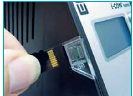
2. ábra. Az operátor által nem változtatható beállítások vihetők be a készülékbe mikro SD-kártyával
