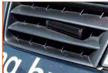
A LASERPRO 3 lézerblokkoló beszerelve
