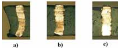
12. ábra. PLAS-, illetve PAS-technológiával szinterelt viák keresztmetszete: a) PLAS-technológia; b) PAS-technológia; c) PAS-technológia
