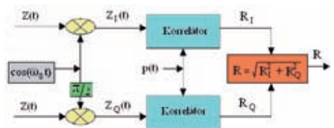
28. ábra. Korrelációs vevő felépítése
