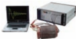
3. ábra. Az SPS Electronic cég ST 3800 típusú szigetelésvizsgálója „munkában”
