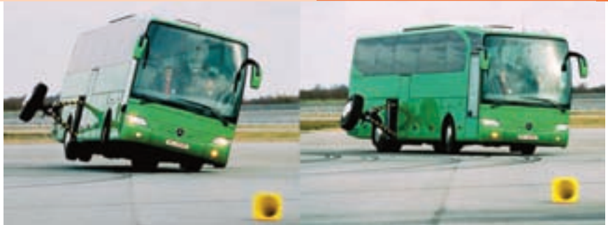
21. ábra. Autóbusz kanyarodása RSP nélkül és RSP-vel
