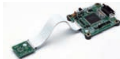
4. ábra. Az EVBSH7125-Carrier-Boardot (USB, E8 vagy E10A) egyszerűen a Target-Boardra kell feltűzni
