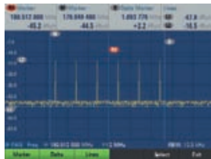
6. ábra. Rádiók műszaki ellenőrzése spektrumvizsgálattal: a vett jel össze-tevőinek a jelölőkkel kijelölt határokon belül kell lenniük
