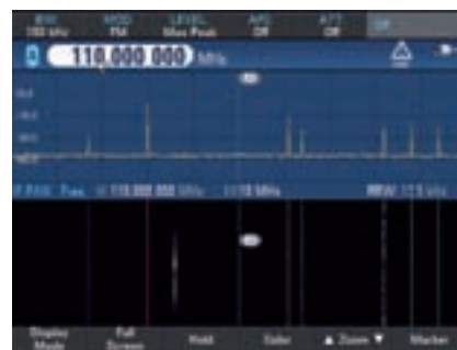
4. ábra. A vizsgálandó frekvenciasáv megkeresését és behatárolását követően a „KF-panoráma” mérési mód segítségével folyamatosan, valós időben figyelhető meg egy legfeljebb 10 MHz széles tartomány
