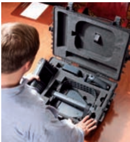
7. ábra. Az R&S PR100 típusú vevő és az R&S HE300 típusú antenna a részegységeivel együtt masszív hordtáskában kap helyet
