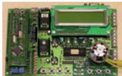
1. ábra. A beültethető EVBSH7125 board Carrier-USB, USB interfész soros Debugger, HMON monitorral
