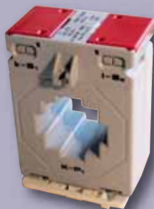
13. ábra. Készre szerelt Ganz áramváltó képe (MAK 74/40, 800/5 A, 15 VA, CI 1)
