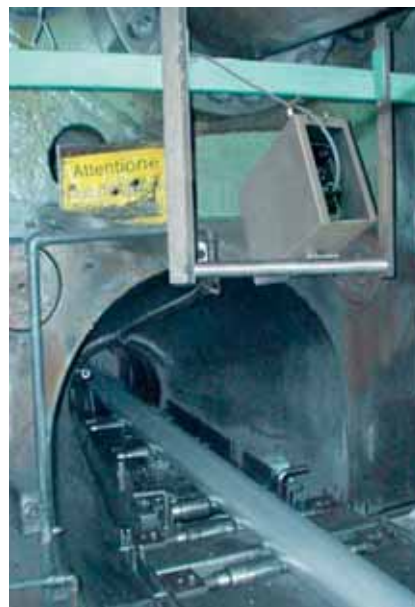
5. ábra. Alumínium hőmérsékletének mérése extrudálásnál
