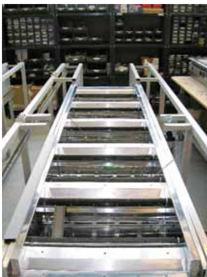
2. ábra. TWS 1400 kemence gyári össze-szerelés közben. Jól látszanak a keresztirányú fűtőbetétek és a hengeres ventilátorok
