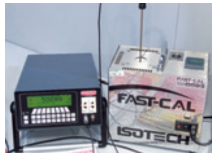
1. ábra. ISOTECH FAST-CAL fémtömbkalibrátor – precíziós hőmérővel
