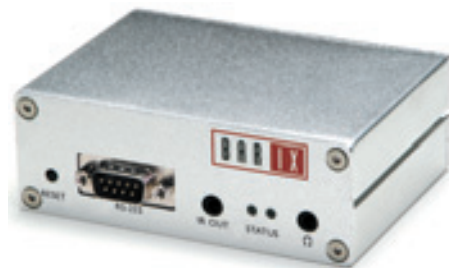
1. ábra. Barix Instreamer 100: hálózati audiokódoló kereskedelmi, ipari és biztonságtechnikai alkalmazásra
