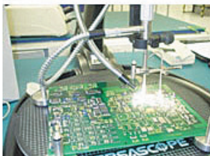
1. ábra. Néhány részlet a Retronix üzemből: alkatrészcseré, 3D röntgenberendezés, BGA-forrasztás optikai ellenőrzése
