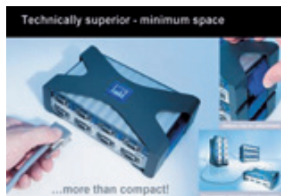
5. ábra. A Quantumx adatgyűjtőhöz CAN-busszal is lehet csatlakozni
