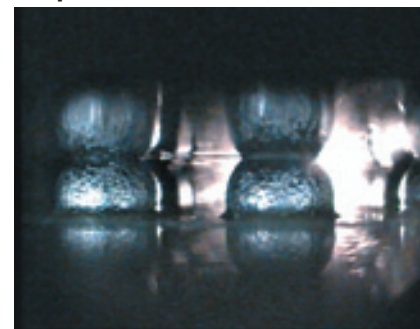
3. ábra. BGA-labdák ellenőrzése, mérése
