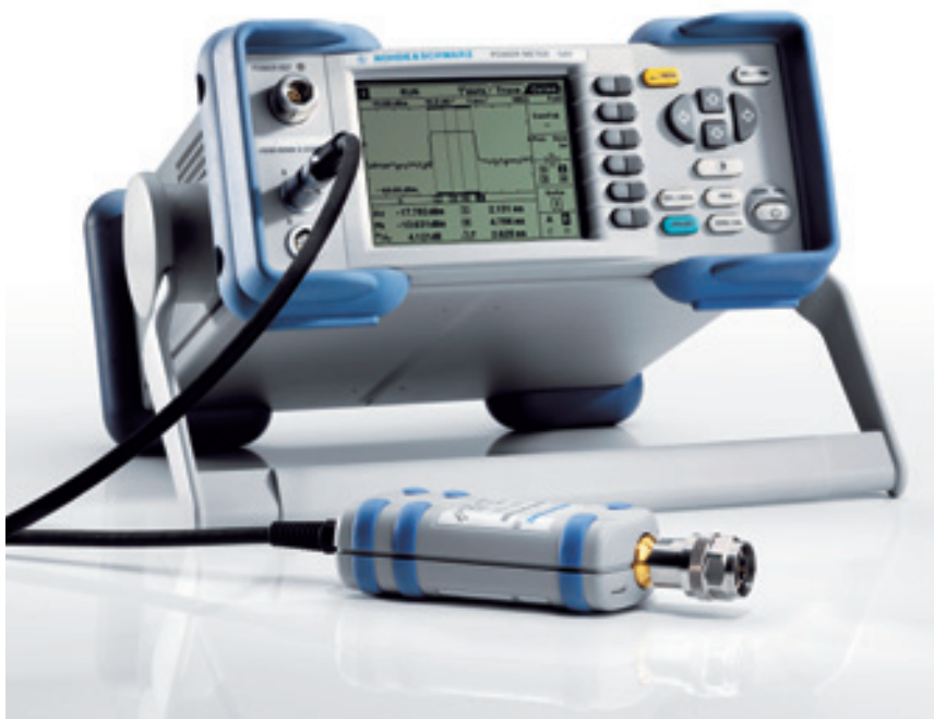
1. ábra. R&S NRP típusú teljesítménymérő az R&S NRP-Z81 típusú, szélessávú mérőfejjel
