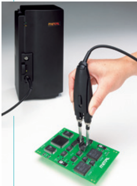
7. ábra. Precíziós szerszám ki/beforrasztáshoz
