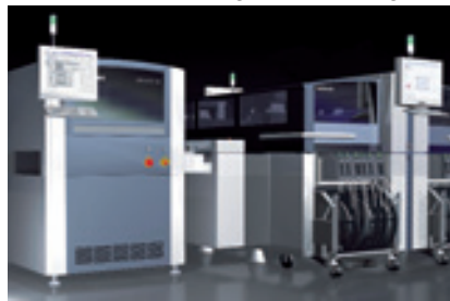
8. ábra. Siplace OS: párhuzamos 2D/3D vizsgálat elsőként a világon
