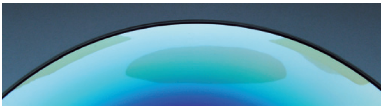
5. ábra. CD-tasak ragasztójának bediffundálása az adathordozóba
