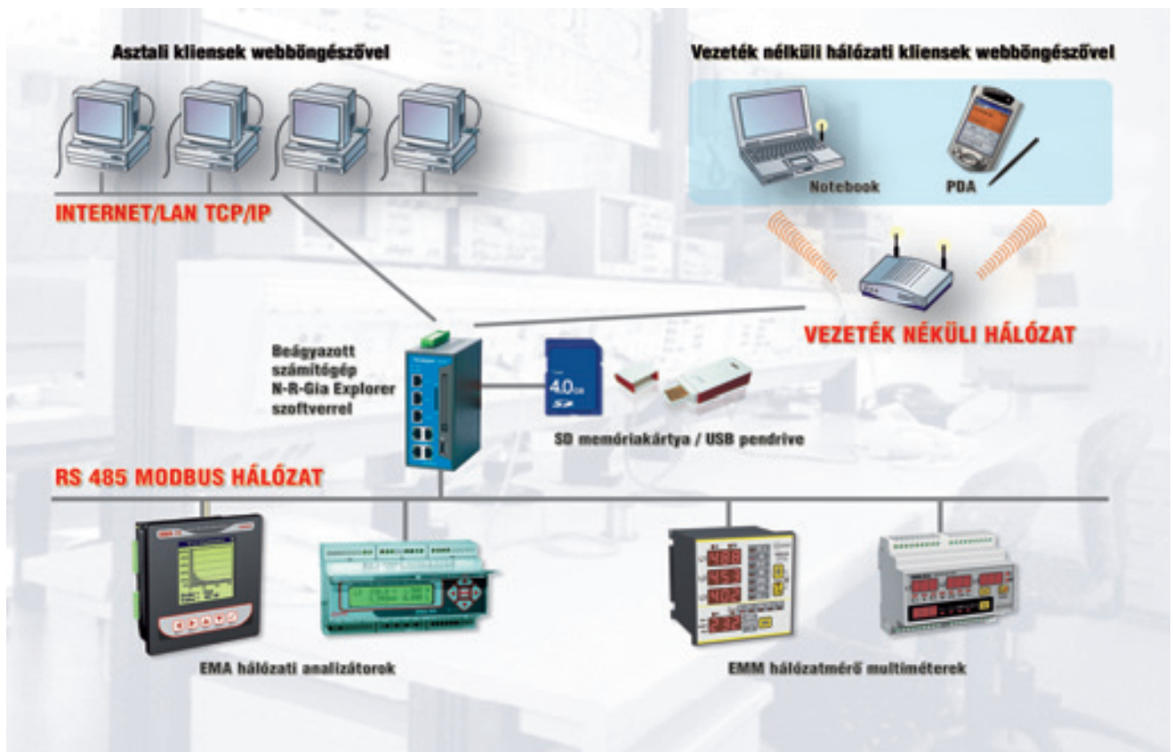
3. ábra. A hálózatfelügyelet beágyazott PC-n futó N-R-Gia explorerrel
