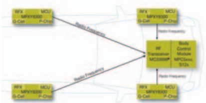
10. ábra. A guminyomás-ellenőrző rendszer elhelyezése a kerekekben
