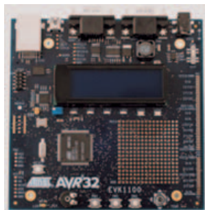
6. ábra. ATEVK1100 fejlesztőkészlet az UC3A processzor-családhoz
