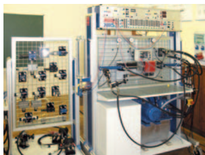
2. ábra. Hidraulikus lineáris szánegység
