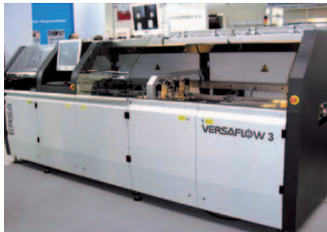
4. ábra. A moduláris felépítésű Versaflow 3 kétpályás, 4 forrasztótégelyes kivitelben
