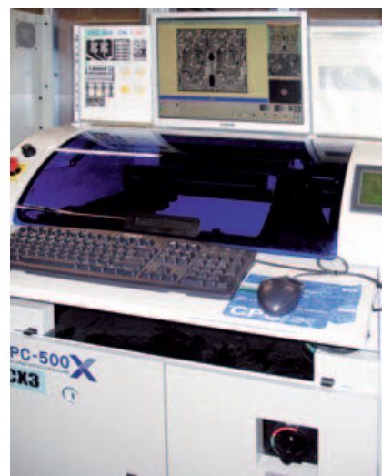
3. ábra. Sony AOI-berendezés
