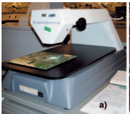
7. ábra. 3D-s pasztamagasság-mérés: a) mikroszkóp, b) kép
