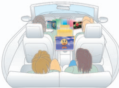
3. ábra. Három látószögből más-más olvasható LCD-panel
