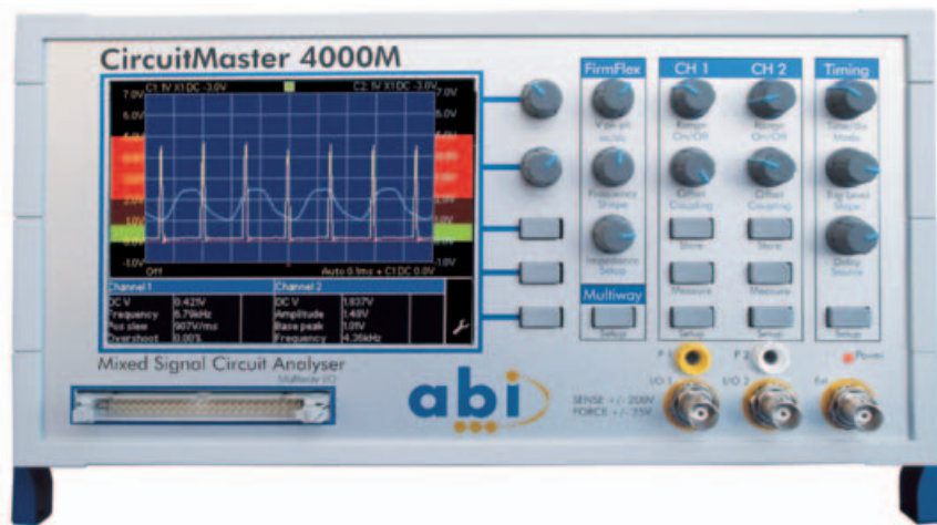
1. ábra. A CircuitMaster4000M precíziós, aktív oszcilloszkóp
