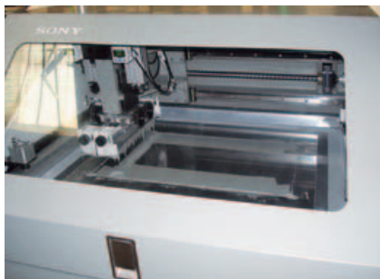
5. ábra. A Sony stencilnyomatógép
