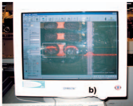
7. ábra. 3D-s pasztamagasság-mérés: a) mikroszkóp, b) kép
