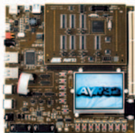
5. ábra. Az ATSTK1000 fejlesztőpanel
