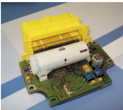
11. ábra. Légzsákfelfújó automatika a Boschtól
