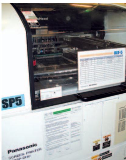
2. ábra. Panasonic stencil printer a gyártósoron
