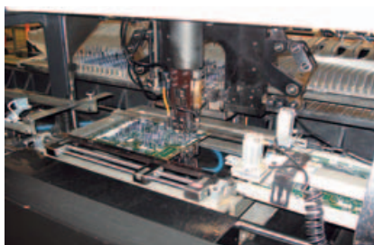
1. ábra. Panasonic beültetőgép furatszerelt technológiára
