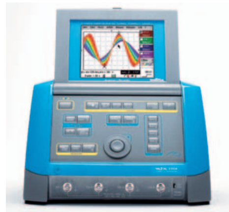
2. ábra. Felhajtható kijelzős, egeres MTX oszcilloszkóp
