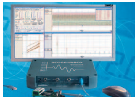
5. ábra. A Scope in @Box kijelzője a számítógép monitora
