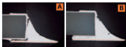
4. ábra. Keresztcsiszolatok összehasonlítása: SAC (A) és S3NXI (B)
