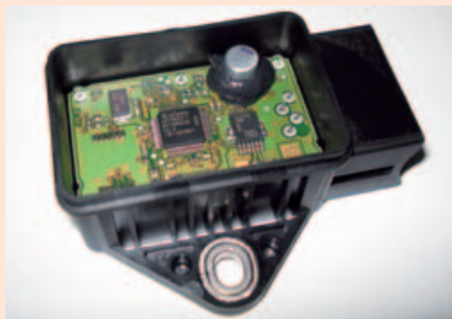
1. ábra. Az ESP-automatika elektronikus panelja
