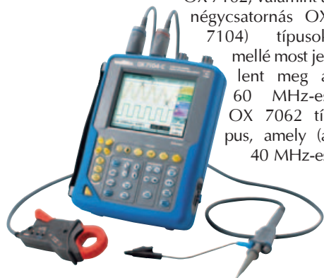
4. ábra. Hordozható Metrix oszcilloszkóp kétféle Probox mérőfejjel
