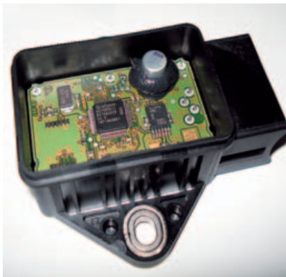
7. ábra. ESP-elektronika a Boschtól
