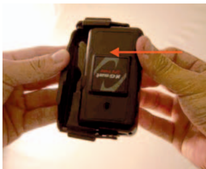
1. ábra. Az új TR-151 GPRS/GPS helyzetjelző
