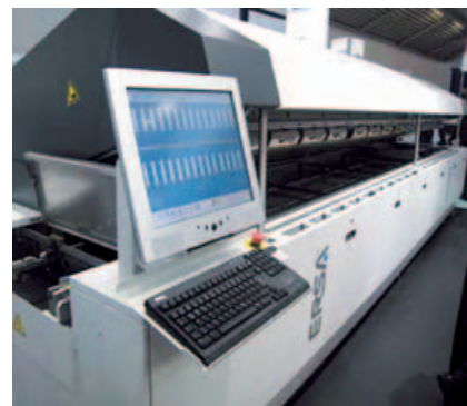
3. ábra. Nagy sebesség, erőteljes fűtési és hűtési teljesítmény, csekély karbantartási igény jellemzi az ERSA új „high end-high volume” reflow-kemencéjét a Hotflow 3/20-at
