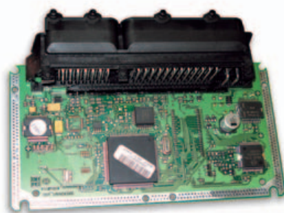
6. ábra. A hatvani Bosch-gyárban készült motorvezérlő elektronika
