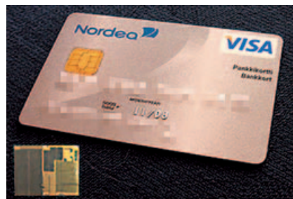
5. ábra. Finn smart card, alatta a kártyába épített 3x3 mm-es chip nagyított képe
