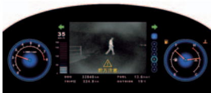
6. ábra. Sötétben látó CCD-kamera képe a kijelzőn
