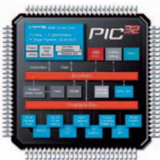
1. ábra. Az új PIC32 32 bites mikrovezérlő blokkvázlata
