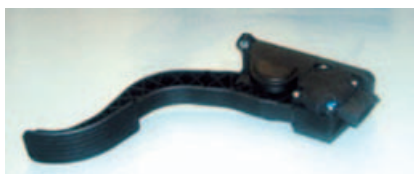
1. ábra. Elektronikus gázpedál (Bosch)
