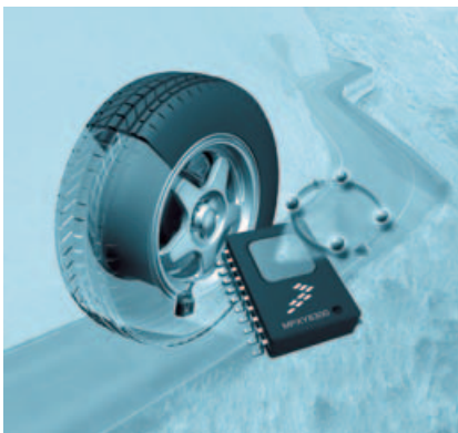
9. ábra. Guminyomás-ellenőrző chip a gumiköpenyben
