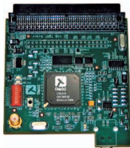
3. ábra. ChipX CX6200-alapú USB 2.0 HS OTG adóvevő- és makrocella-tesztkártá
