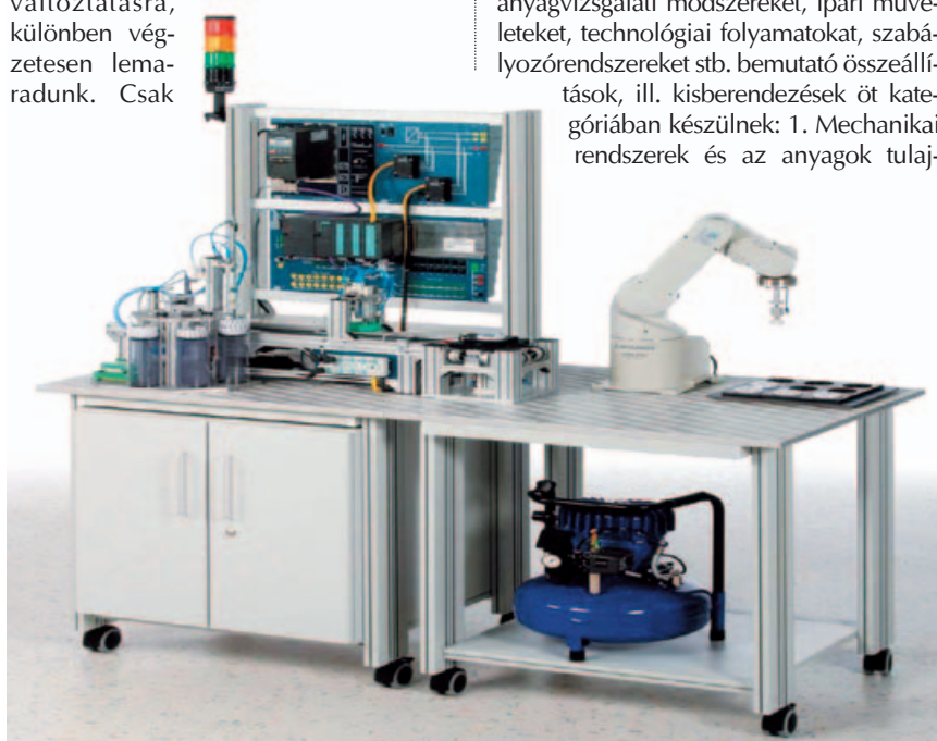
1. ábra. Anyagmozgatás és ipari robot, vákuumos megfogó rendszerrel
