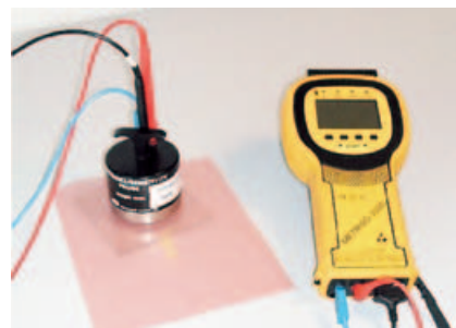
2. ábra. Felületi ellenállás mérése
