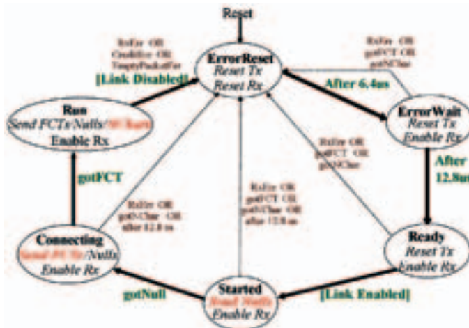
7. ábra. A SpaceWire interfész állapotdiagramja
