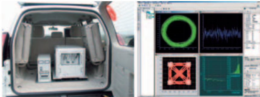
2. ábra. A Huari az NI PXI-platformot és RF-modulokat használ a tökéletesebb spektrum-monitorozáshoz
