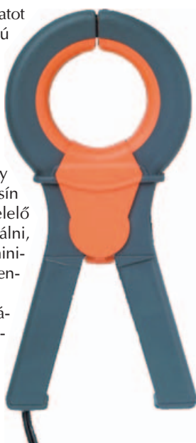
1. ábra. A HT97U típusjelű, nagyáramú AC lakatfogó
