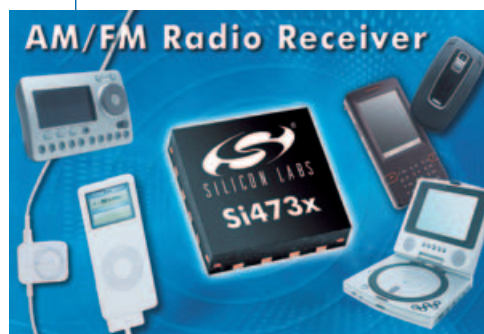
4. ábra. Silicon Labs Si473x: integrált AM/FM rádióvevő
