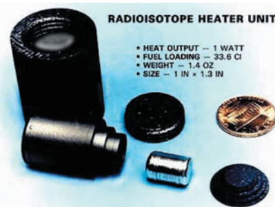
5. ábra. Az űrszondák érzékeny műszereinek, eszközeinek helyi melegítésére szolgáló ^{238}\text{PuO}_2 izotópos fűtőegység (RHU). A kép közepén az ezüstsínű, kb. 2,7 g-os, 8 mm átmérőjű üzemanyagpellel [5]
