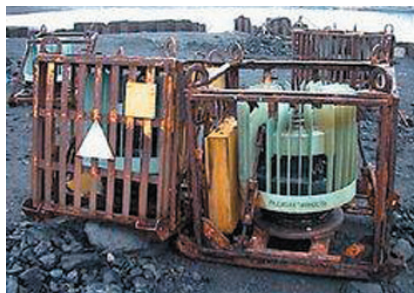
4. ábra. Fémtolvajok által megrongált használaton kívüli ^{90}\text{Sr} -izotópos orosz termogenerátorok [7]
