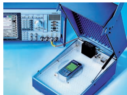
1. ábra. Mobiltelefonok hatékony bevizsgálása és javítása: mindezt az R&S®CMU200 típusú műszer az R&S®CMU-Z10 típusú antennacsatolóval, az R&S®CMU-Z11 típusú árnyékolóval és az ingyenes R&S®CMUgo szoftverrel biztosítja
