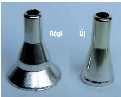
3. ábra. Ólommentes forrasztáshoz kifejlesztett új forraszfúvóka
