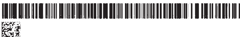
2. ábra. A DMC és a vonalkód méretbeli összehasonlítása, a karakterek száma megegyezik
