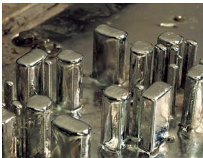
4. ábra. A Multiwave modul „kéményeiből” feltörő forrasz
