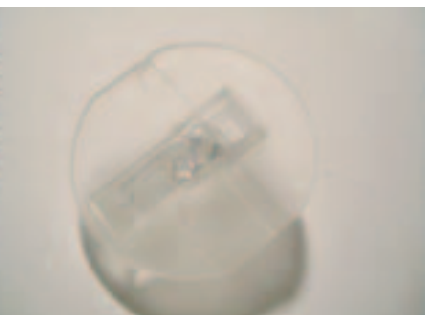
10. ábra. A lézeregér optikai szerkezete: a) képfeldolgozó csip, b) lézerdióda
