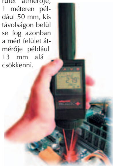
2. ábra. Az Optris LaserSight fordított kijelzővel SMD alkatrész vizsgálata közben
