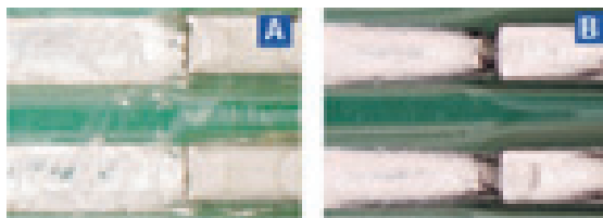
6. ábra. A viszkozitás változása folyamatos nyomtatás közben
