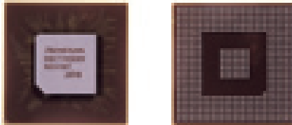
2. ábra. Az SH7774 controller gépkocsi információs termináljához
