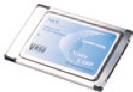
6. ábra. N-huzalos PCMCIA-kártyával megvalósított debugger
