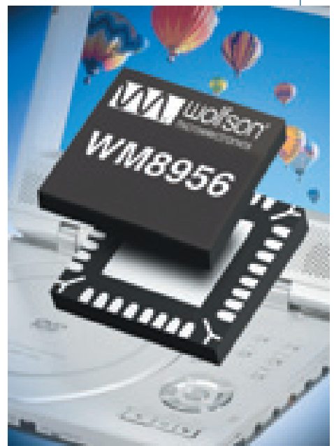
3. ábra. A Wolfson Microelectronics WM8956 D/A-átalakítója
