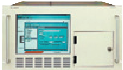
6. ábra. Ipari számítógépmódul TFT-kijelzővel
