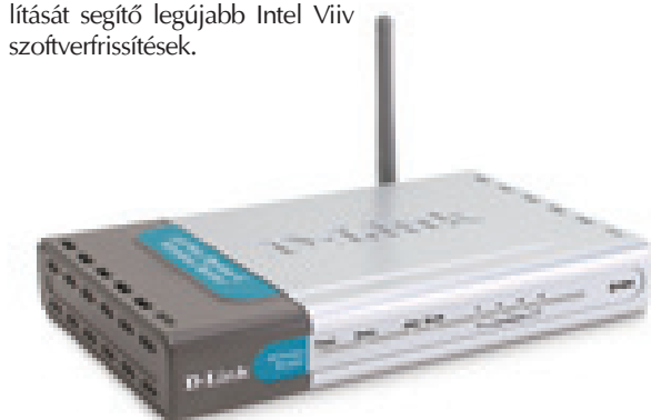
4. ábra. DI-624 wireless hozzáférési pont Internet Gateway switch-csel
