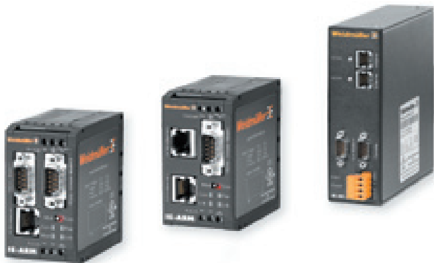
2. ábra. Weidmüller router – a routerek használata független IP-címekkel rendelkező alhálózatokra való felosztást és az internethez való biztonságos kapcsolódást tesz lehetővé
