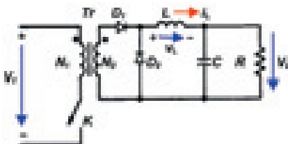
13. ábra. A nyitó (Forward) konverter elvi kapcsolási vázlata
