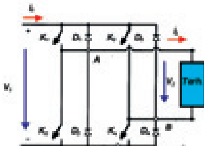
11. ábra. Hídkapcsolású (Full bridge) konverter kapcsolási vázlat
