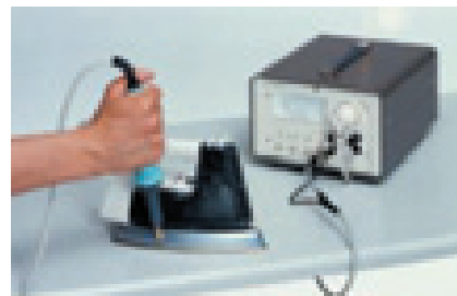
3. ábra. Védővezető folytonossági ellenállás mérése a gyakorlatban
