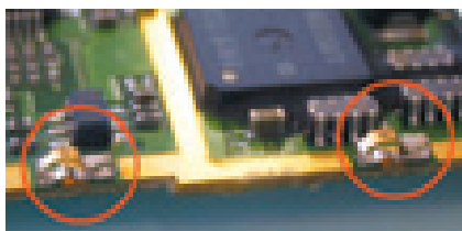
5.a. ábra. OG-Contactok a GND-vezetőn
