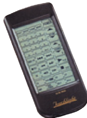
5. ábra. „Tanítható” érintőképernyős infravörös távirányító, 8 különböző audiovizuális készülék vezérlésére (SUR 9000 típus)
