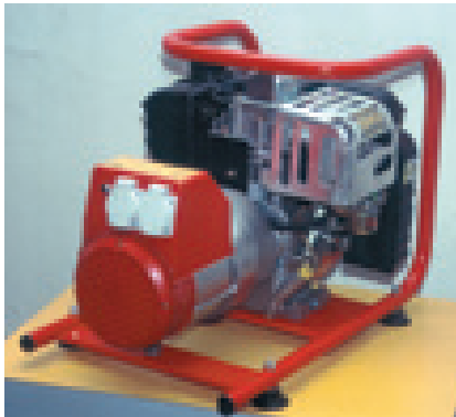
17. ábra. BEA 1-2200 típusjelű 1800 VA tartós teljesítményt nyújtó benzinmotoros áramfejlesztő (Agrimotor Kft.)
