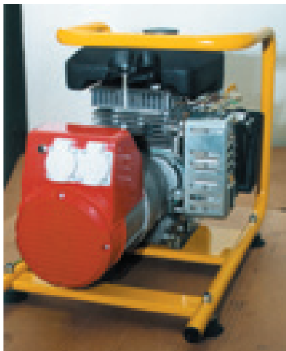
16. ábra. BEA 1-2200 1800 VA tartós teljesítményt nyújtó, ipari kivitelű benzinmotoros áramfejlesztő (Agrimotor Kft.)
