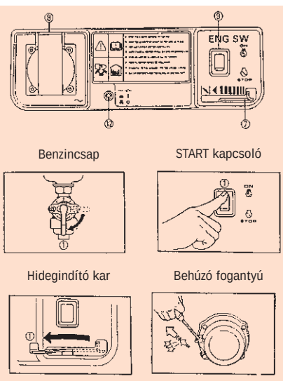
6. ábra. Az ESE 900 típusú, 650 VA tartós teljesítmény leadására képes, benzinmotoros áramfejlesztő kezelőszervei
