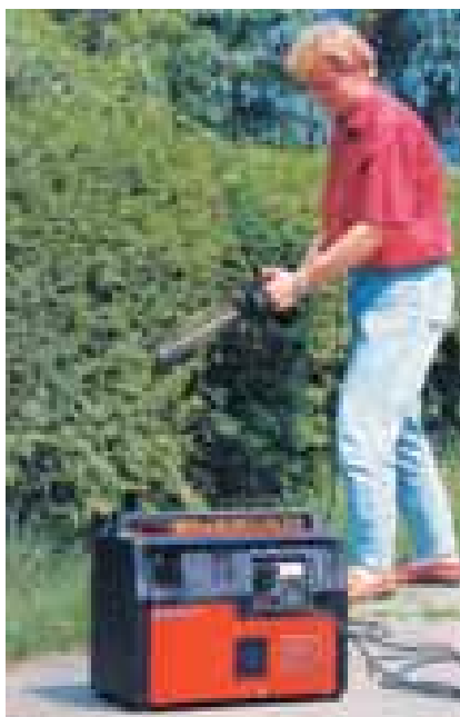
2. ábra. 230 V/50 Hz-es, 2000 VA-es, hordozható áramfejlesztő (ENDRESS)
