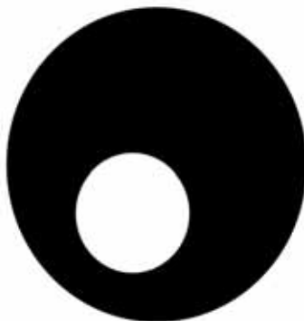
4. ábra. A fehér terület egy üreg relatív területének kötelező nagyságát mutatja, amely 15% üregesedési arányt ad meg a röntgensugaras vizsgálat alatt
