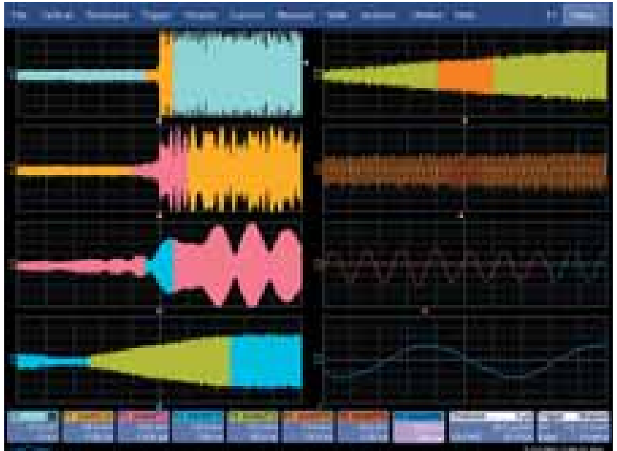
3. ábra. Ez a képernyőfotó egy komplex hullámformát prezentál, amelyet 20 gigaminta/s mintavételezési sebességgel és nyolc, egymást követő zoommal rögzítettek. A forrás-hullámforma bal- fent 20 ms-os rögzítési időt reprezentál, míg a végleges ráközelítéssel készült jobb alsó 200 ps hosszú ablakban mutatja az összes adatpontot
