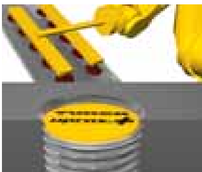
4. ábra. Az uprox+ érzékelők védett szerelése: a) és b) ábra. A sajtolószerszámba süllyesztett, mechanikai sérüléstől védve beépített érzékelő
