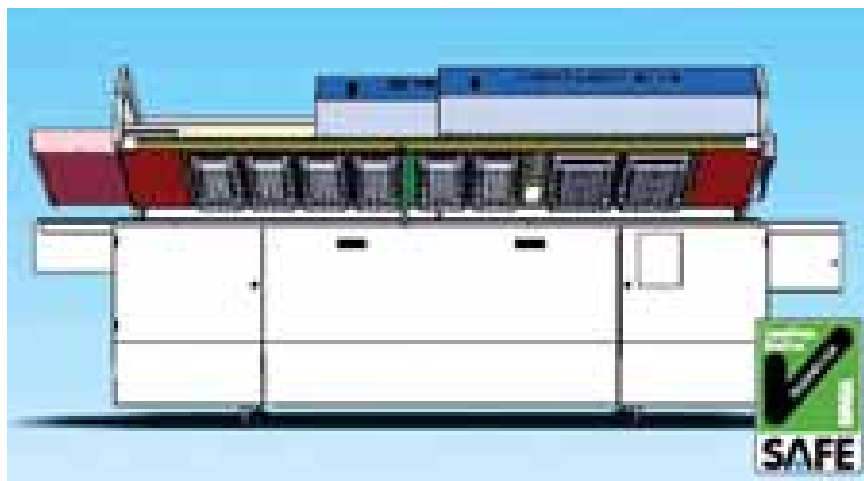
1. ábra. Az ERSA Hotflow 2/12 reflow-kemence előlnézete. A felső borítás eltávolítható, a részegységek könnyen hozzáférhetők
