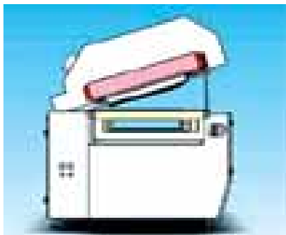
1. ábra. Az ERSA Hotflow 2/12 reflow-kemence előlnézete. A felső borítás eltávolítható, a részegységek könnyen hozzáférhetők
