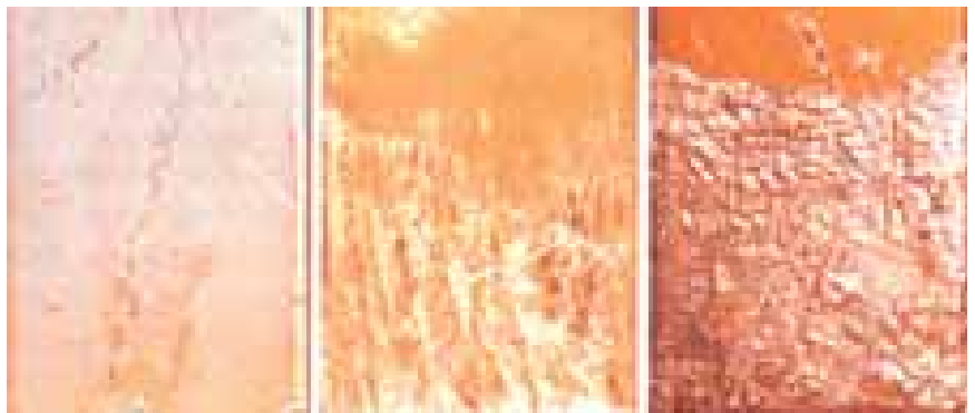
4. ábra. Bevonat nélküli 304-es típusú rozsdamentes acélmintákat nedvesítette a forrasz
