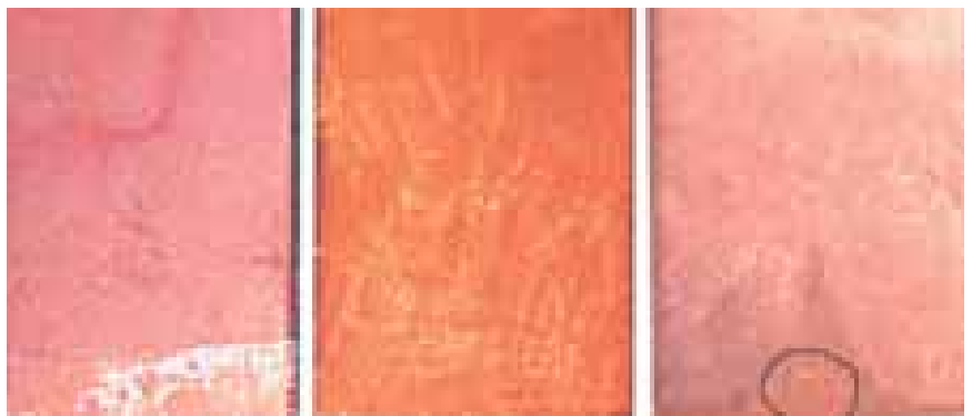
5. ábra. Melonitbevonatú 304-es típusú rozsdamentes acélminták nedvesítése csak 8 hét eltelte után volt tapasztalható, de ekkor is csak a karcok helyén
