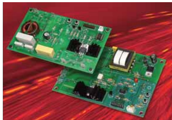
Precíziós triakos motorfordulatszám-szabályozó elektronika
