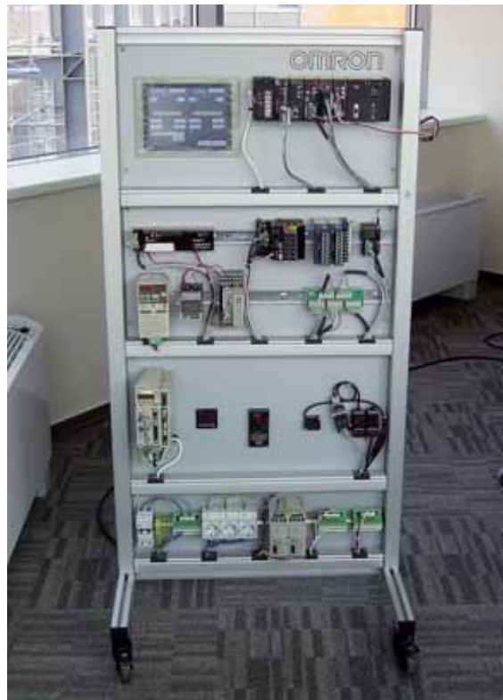
Demonstrációs összeállítás a PLC-oktatásban a laborban
