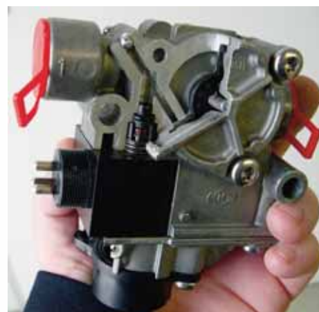
16. ábra. Elektromágneses ABS-szelep, amely 2 db elővezérlő elektromágnesből és 2 db nagy keresztmetszetű membrán-szelepből áll. Árammentes alaphelyzetben átengedi a sűrített levegőt, ha az egyik elektromágnes kap gerjesztő áramot nyomást tart, ha mindkettő, nyomást csökkent
