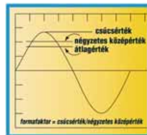
4. ábra. Az átlagérték-alapú váltakozóáram-mérők az egyenirányított jel átlagértékét mérik, amelyet egy tényezővel felszorozva adják meg a „négyzetes középértéket”
