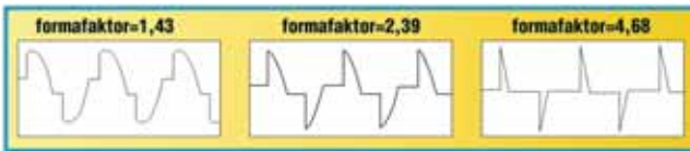
5. ábra. Különböző hullámformák formafaktora
