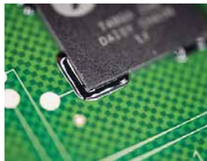
A Henkel cég Loctite 3508 típusszámú anyagával rögzített BGA tok
