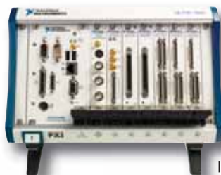
Standard 8 foglalatos PXI-keret beágyazott rendszervezérlővel és hét perifériás modulal
