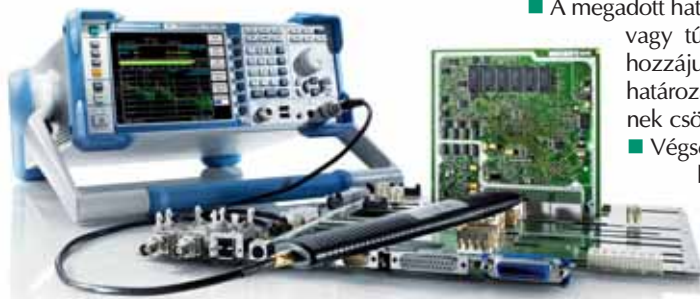
1. ábra. Az R&S ESL típusú műszer és az R&S HZ-14 típusú, közelvér vizsgálatára szolgáló mérőfejlesztés
