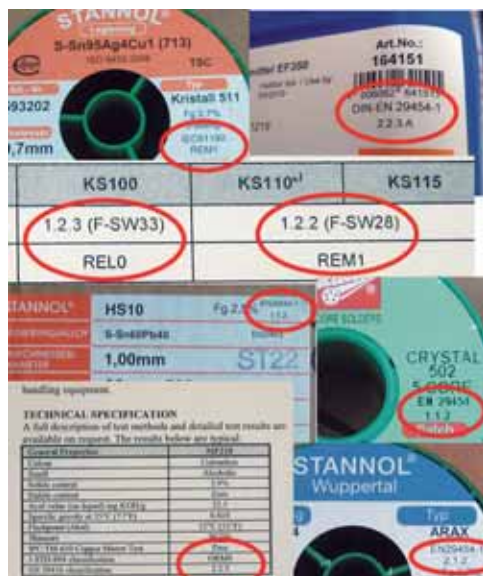
Folyasztószer-besorolás jelölése különféle szabványok szerint, termékeken, adatlapokon, csomagoláson
