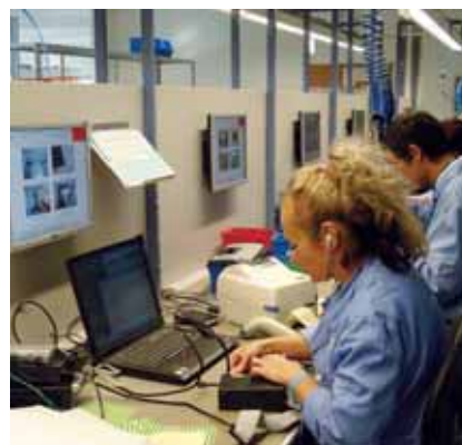
4. ábra. A tesztelés: a termék megkapja a végső vonalkódmatricát. A képen látható dolgozó betanítás alatt áll, ezt jelzi a piros mező a képernyő jobb felső sarkában
