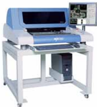
1. ábra. A Mirtec cég MV-3L típusú asztali AOI berendezése
