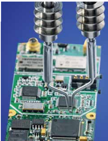
4. ábra. Chipalkatrész kiforrasztása ERSA Chip-tool kiforrasztócsipeszsel
