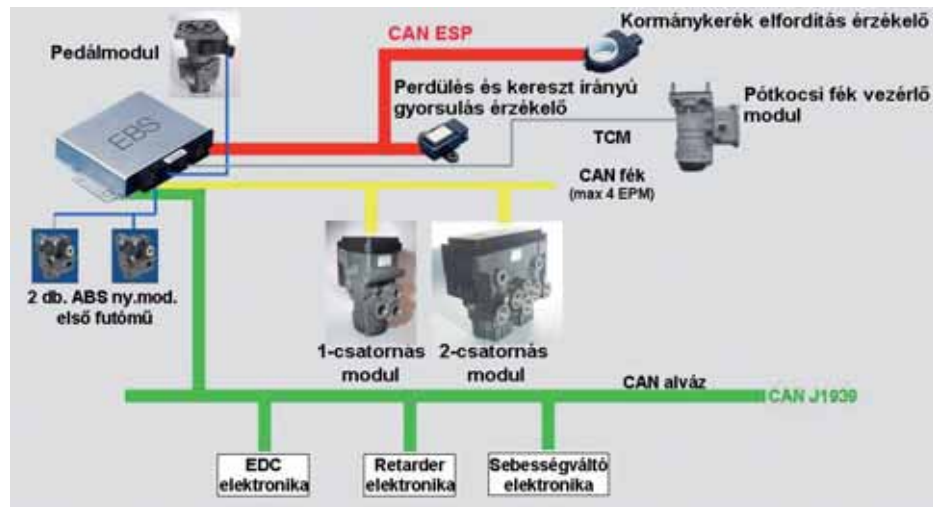
5. ábra. A Knorr-Bremse elektronikus légfékrendszere épülő ESP-rendszere
