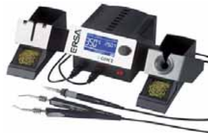
1. ábra. ERSA i-CON2 elektronikus szabályozású rework forrasztóállomás kicsi, de 150 W teljesítményű, könnyen cserélhető hegyű pákával és SMD kiforrasztócsipesszel
