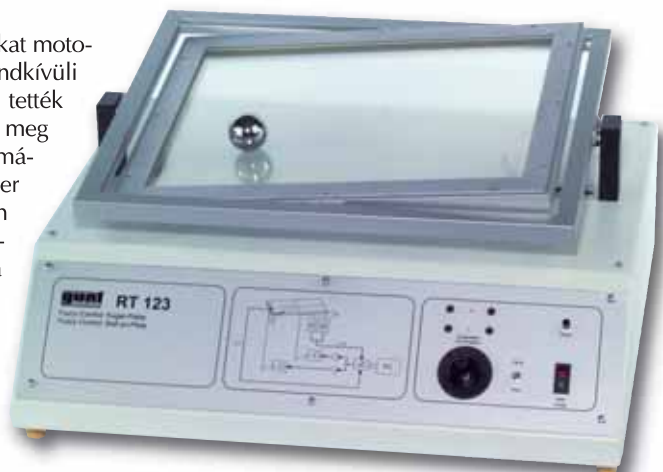
4. ábra. „Golyó a lapon” fuzzy-vezérlés modellezése
