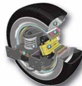
4. ábra. Integrált kerékagymotor, a kanyarodni is képes eCorner (Forrás: Siemens VDO)
