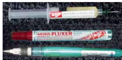
2. ábra. Zselés forrasztóhuzal fecskendőben, folyékony forrasztóhuzal töltött filctoll- és üvegcsés hegyű toll (Multicore illetve Stannol gyártmány)
