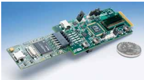
2. ábra. Olcsó fejlesztőplatform kis fogyasztású alkalmazásokhoz beépített Li-ion teleppel: IGLOO Iclicle Kit
