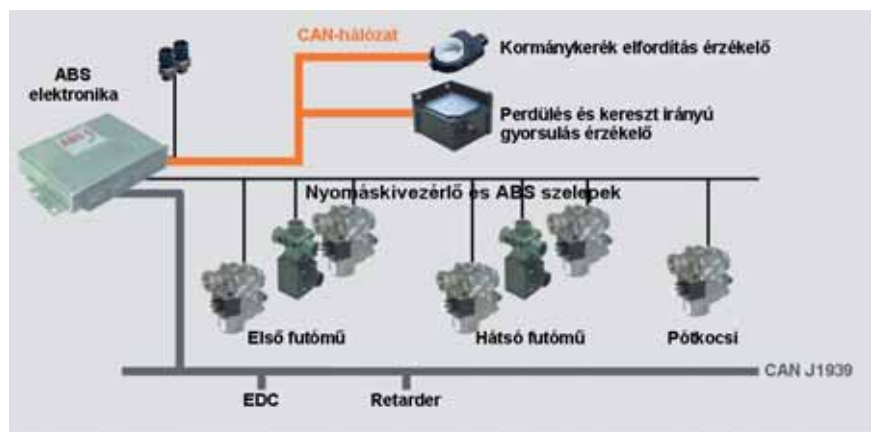
6. ábra. A Knorr-Bremse ABS-rendszere épülő ESP-je
