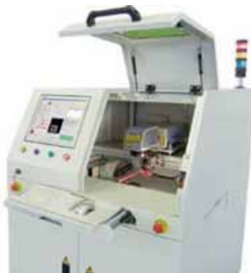
2. ábra. A Nutek cég LMC-3000HE típusszámú lézeres jelölő berendezése
