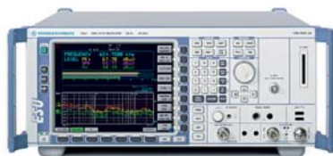
3. ábra. A R & S elektromágneses interferencia vizsgálatára szolgáló, ESL típusú készülék
