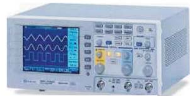
4. ábra. A GDS-806/810 típusú digitális tárolós oszcilloszkóp
