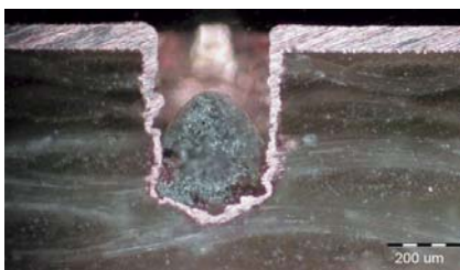
9. ábra. A 300 µm-es zsákfurat galvanizálás után
