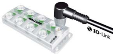
1. ábra. A Balluff-szenzorhub a hagyományos kapcsolók jeleit gyűjti és egy egyszerű, háromeres kábel és az IO-Link segítségével továbbítja a vezérlésbe
