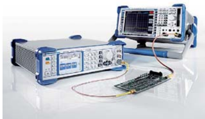
2. ábra. A R & S SMB100A típusú jelgenerátora egy FM sztereovevő vizsgálatában
