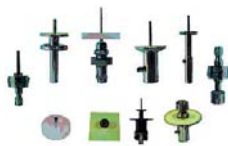
1. ábra. ESE alkatrészfelvevő pipetták Fuji beültetőgépekhez
