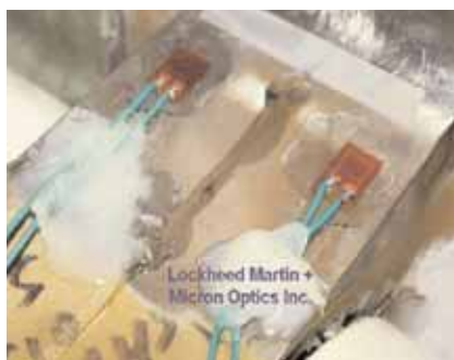
14. ábra. Két nyúlásmérőt és egy FBG szenzort tartalmazó összeállítás
