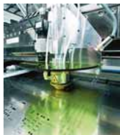
3. ábra. Stencil lézeres vágása
