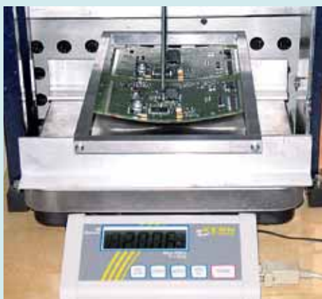
1. ábra. Szerelőlemezek deformációs teszjtéjez fejlesztett prés –
