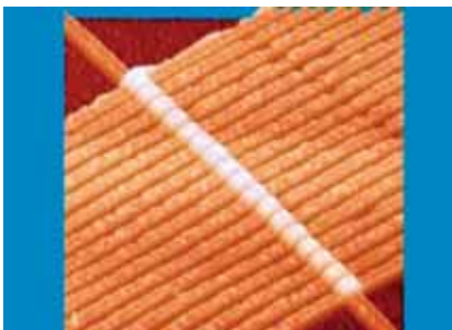
1. ábra. A HP-laboratóriumban megalkotott memrisztor képe. (Forrás: http://blog.wired.com/gadgets/2008/04/scientists-prov.html )
