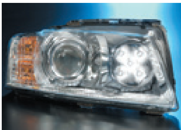
4. ábra. LED-es helyzetjelző lámpa az Audiban
