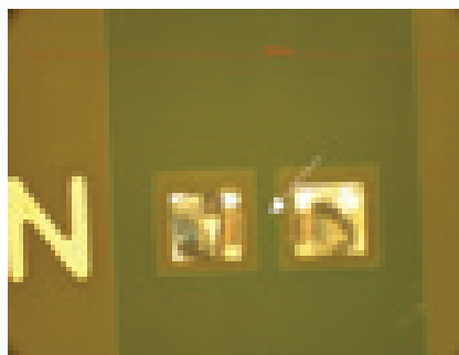
9. ábra. A 0402-es chipkondenzátor alatt nem marad szennyeződés
