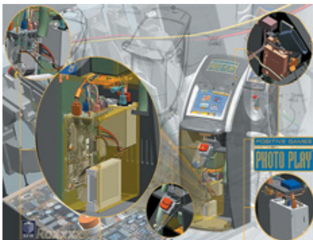
2. ábra. OrCAD-del és Solid Edge-dzsel tervezett játékautomata
