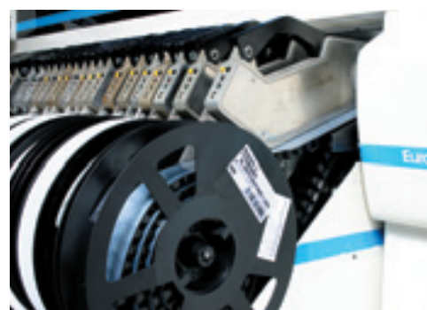
4. ábra. Az automatizálásnak megfelelő csomagolás – Tape-on reel – lehetővé teszi azt, hogy a csatlakozókat együtt dolgozzák fel más alkatrészekkel újraömllesztéses eljárásban
