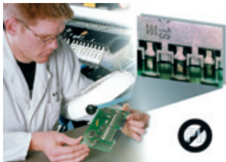
1. ábra. Az SL-SMT-csatlakozók termék-konstrukciója olyan, hogy a forrasztás minősége a forrasztási meniszkusz optikai ellenőrzésével megállapítható. Részlet: egy helyesen kialakított meniszkusz köszörült képe
