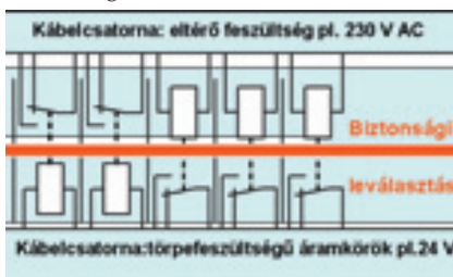
1. ábra. Elvi kialakítás: biztonsági leválasztás a kapcsolószekrényben
