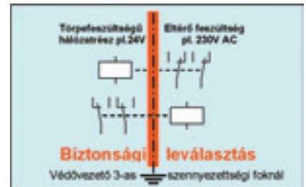
4. ábra. Elvi kialakítás: biztonsági leválasztás a nyomatott áramköri lapon
