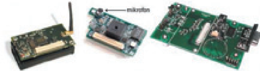
2. ábra. Berkeley MICAz mote, szenzorkártya és programozókártya
